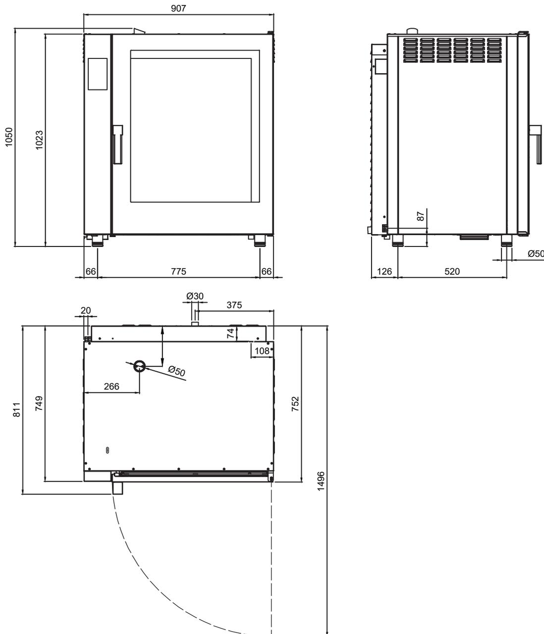
Four à convection électrique Vapeur directe Écran tactile couleur Nettoyage automatique Porte battante à droite 10x GN 1/1
